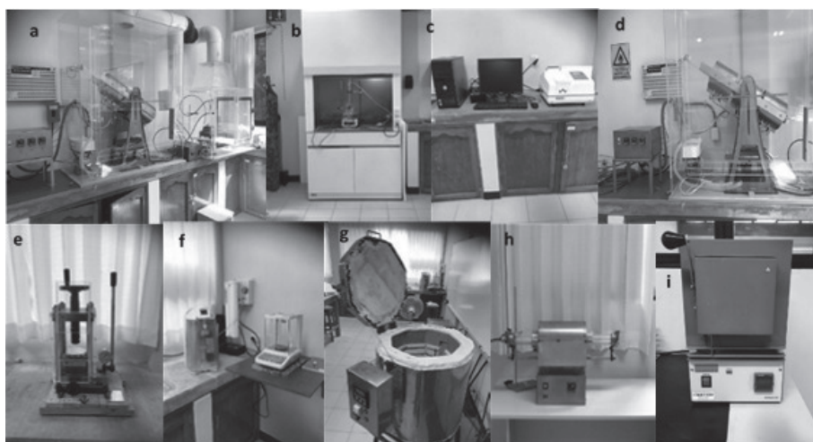
Figura 1. Equipos para síntesis de materiales luminiscentes, a) Sistemas RPU, b) Sistema Poliol, c) Espectrofotómetro de fluorescencia, d) Sistema RPU de tres zonas, e) Prensa, f) Balanza analítica y sistema de agua desionizada, g) Horno para recubrimiento artesanías barro negro, h) Horno tipo tubo de cuarzo, i) Mufla de 1100°C.
