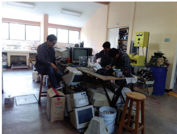
Figura 4. Desensamble de aparatos eléctricos/electrónicos en el Laboratorio Minero-Metalúrgico del Instituto de Minería.
