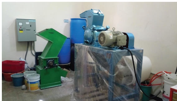
Figura 5. Molino para polímeros (verde) y molino para vidrio (azul).
