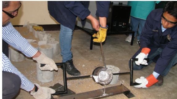
Figura 11. Práctica de fundición de aluminio proveniente de los residuos de aparatos eléctricos/electrónicos.
